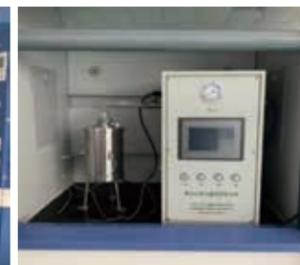
粉塵雲最低着火温度試験システムMITC
